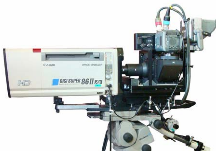
写真左：単眼スプリッター方式 3D 撮影システム (86 倍ズームレンズを装着した状態)
