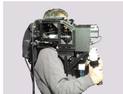
写真左：単眼スプリッター方式 3D 撮影システム (86 倍ズームレンズを装着した状態)
